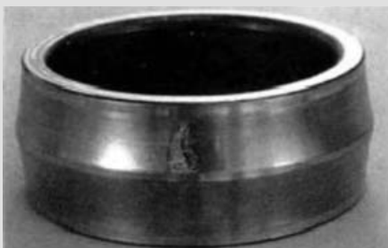
شکل ۳۱- پوسته شدن حلقه داخلی رولبرینگ بشکه‌ای
