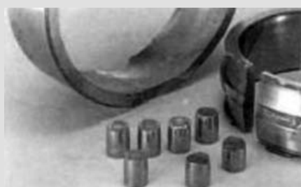
شکل ۶- ترک و لب‌پریدگی در یک رولبرینگ بشکه‌ای
