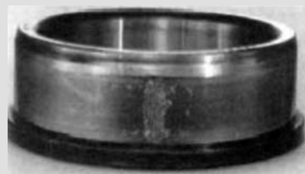
شکل ۰۱- پوسته پوسته شدن حلقه داخلی رولبرینگ استوانه‌ای
