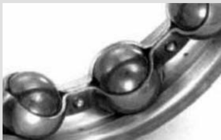
شکل ۳۲- تغییر رنگ ساچمه بلبرینگ شیار عمیق
