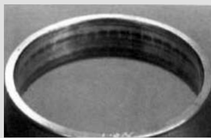
شکل ۲۳- خزش در حلقه داخلی رولبرینگ مخروطی
