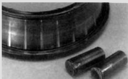
شکل ۵۲- تغییر رنگ حلقه داخلی و غلتک های رولبرینگ مخروطی
