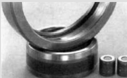
شکل ۴۲- تغییر رنگ شیار غلتک و سطح غلتک رولبرینگ استوانه ای
