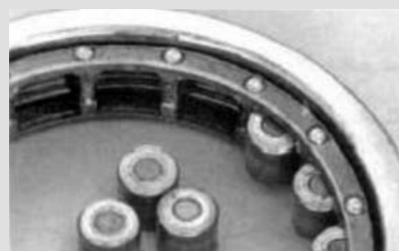
شکل ۱۳- گیرپاژ در رولبرینگ استوانه‌ای
