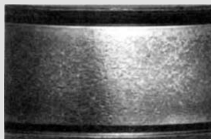
شکل ۳- برینل شدن سطح شیار غلتک حلقه داخلی رولبرینگ مخروطی
