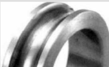
شکل ۸۱- لکه روی شیار ساچمه حلقه داخلی بلبرینگ شیار عمیق
