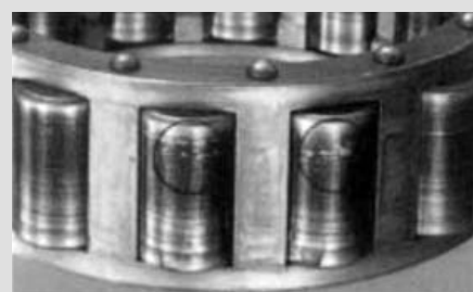
شکل ۲۲- لکه روی غلتک های رولبرینگ استوانه ای
